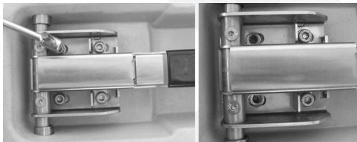
5 - Dévisser les 2 vis à tête cylindrique en acier inoxydable à six pans creux M8x16 avec leurs rondelles-gorges en inox (les deux dernières vis sont placées à droite)
