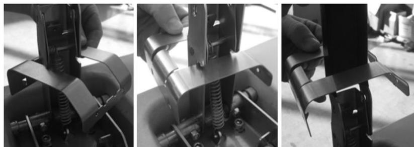
3 - Svitare le 2 viti inox testa cilindrica con esagono incassato M8x16 con le relative rondelle inox groover (viti posizionate a sinistra, a fianco dell'asta)
