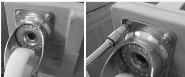
3 - Togliere la ruota interessata e sostituire con la nuova ruota
