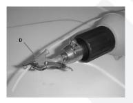
7 - Posizionare il beccuccio in prossimità della zona da saldare e lasciare depositare il polietilene fuso. La velocità di trascinamento della saldatrice è funzione della temperatura impostata sul termostato e delle dimensioni della parte da ripristinare. Procedere finché la zona da ripristinare risulti completamente satura di polietilene fuso.
