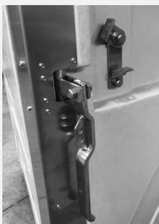
2 - Svitare il dado e la vite antisvitamento M8 con la relativa rondella Ø10mm.
