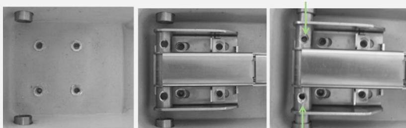
8 - Avvitare le 2 viti inox testa cilindrica con esagono incassato M8x16 con le relative rondelle inox groover (viti posizionate esternamente, sulla destra)
