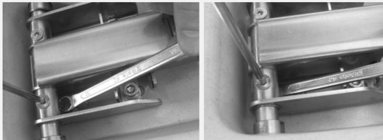
5 - Svitare le 2 viti inox testa cilindrica con esagono incassato M8x16 con le relative rondelle inox groover (ultime due viti posizionate a destra)
