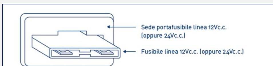
Disegno 4: Fusibile linea tensione continua 12Vc.c.
