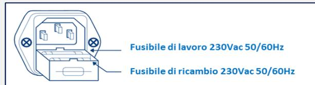
Disegno 3: Fusibile linea tensione alternata 230Vac 50/60Hz
